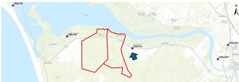
Figura 3. Localização dos piezómetros do SNIRH na envolvente das Herdades (linha vermelha). O piezómetro 476/21 assinalado pela seta azul possui medições actualizadas e está a curta distância.
